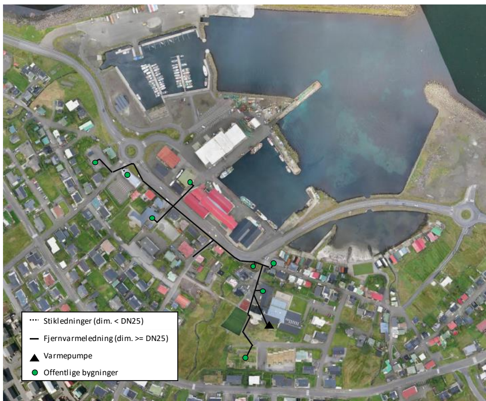
Figur 5.1 Oversigtskort af ledningstracé for del 1, taget fra forundersøgelse fra 2018, hvor varmepumpeplacering er ændret
